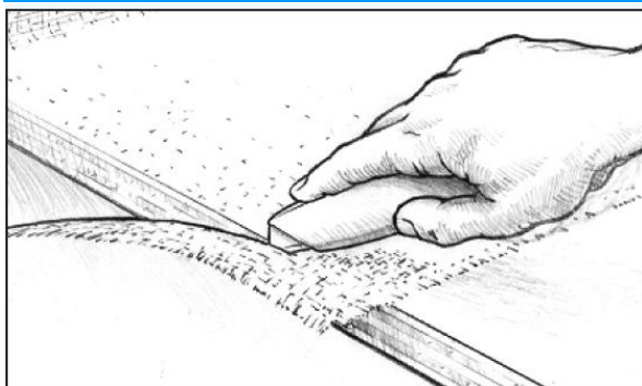
Joonis 25. Lõigake liigne riie ära pärast epoksiidi geelistumist, kuid enne, kui see tugevalt kõveneb.
