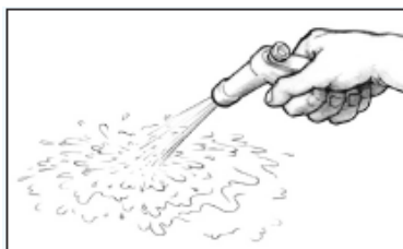
Joonis 33. Loputage pinda pärast lihvimist puhta veega.
