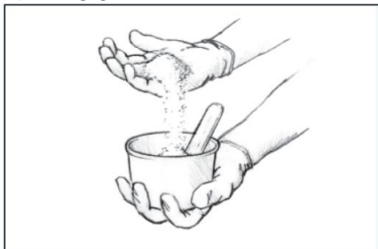
Joonis 4. Segage täiteainet väikestes kogustes, kuni saavutate soovitava konsistentsi.
